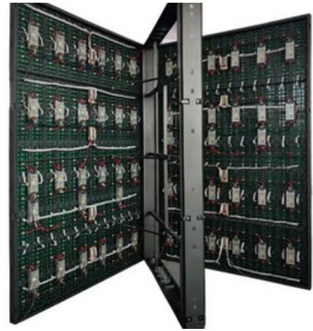
I pannelli LED wall sono schermi modulari composti da LED di svariati pixel della Nation Star utilizzati per creare grandi display video ad alta luminosità e risoluzione. Ideali per pubblicità, eventi e presentazioni, offrono immagini nitide e visibili anche a distanza o in ambienti esterni. Sono personalizzabili in dimensioni e forma grazie alla loro modulabilità, garantendo versatilità e impatto visivo.
